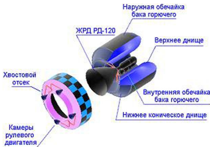
Рис. 8. Сложный торoidalный бак ЖРД «РД-120»
